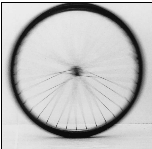
Obr. 12.4 Fotografie valícího se bicyklového kola. Obraz kovových paprsků v dolní části fotografie je podstatně ostřejší než nahoře. Pohyb paprsků v horní části kola je tedy rychlejší, ve shodě s obr. 12.3c.
