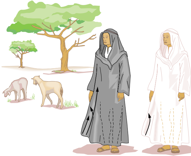
Obr. 19.20 Proudění vzduchu vzhůru pod teplejším černým pláštěm je mnohem mohutnější, než pod chladnějším bílým. (Podle „Why Do Bedouins Wear Black Robes in Hot Deserts?“ (Proč nosí beduíni v horké poušti černé šaty?), A. Shkolnik, C. R. Taylor, V. Finch a A. Borut, Nature , Vol. 283, 24. January, 1980, pp. 373–374.)
