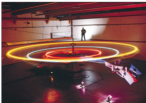
Obr. 11.10 Příklad 11.6. Centrifuga pro výcvik astronautů v německém Kolíně. Při tréninku si astronauti zvykají na velká zrychlení, jimž jsou vystaveni při startu rakety.
