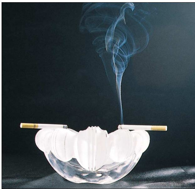
Obr. 15.12 V určitém bodě změni stoupající proud kouře a ohřátého vzduchu charakter proudění z laminárního na turbulentní.
