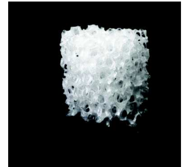
Obr. 3.8: Porézní struktura biologicky resorbovatelné keramiky [42]
