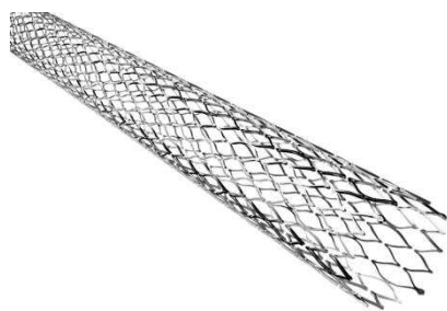
Obr. 3.5: Příklad použití kovu s tvarovou pamětí - Koronární stent [39]
